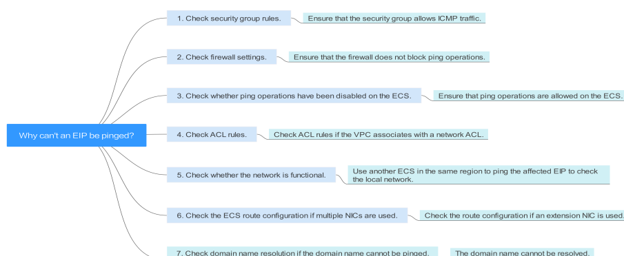
Figura 14-1 Método de localização da falha ao executar ping em um EIP
